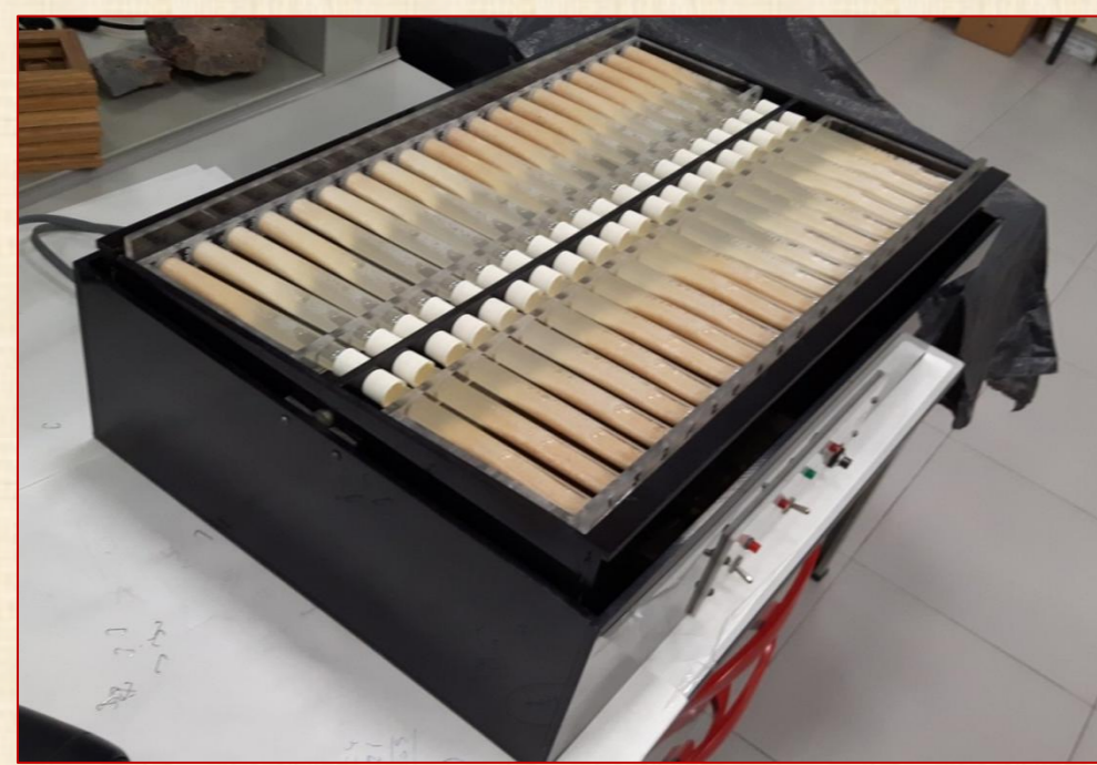
Mecanismo de agitación de tubos para el Test de sedimentación.
